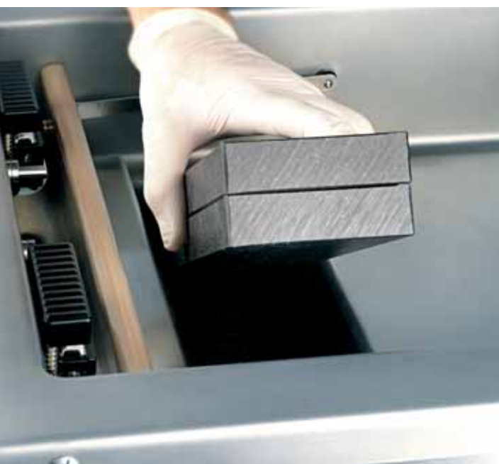
[spessori regolabili per il corretto allineamento dei sacchetti rispetto alla barra saldante]
